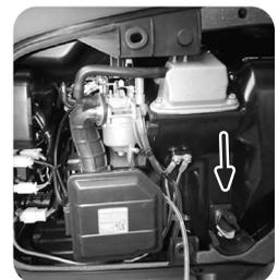
Der Luftfilter muss alle 50 Betriebsstunden gereinigt werden (bei erhöhter Verschmutzung alle 10 Stunden).
