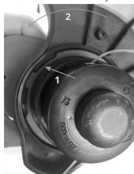
1 - Zwróć uwagę tutaj, aby upewnić się, że jest umieszczony na miejscu. 2 - Obróć tę Osłonę w tym kierunku o około 90 stopni.
