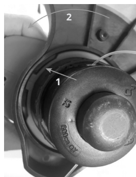
1 - Achten Sie darauf, dass es richtig positioniert ist. 2 - Drehen Sie diesen Schutz etwa 90 Grad in diese Richtung.
