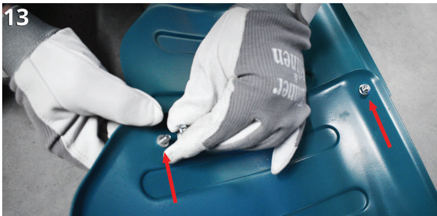
Fig. 14. Fixați aripile pe corpul cultivatorului folosind șuruburi.
