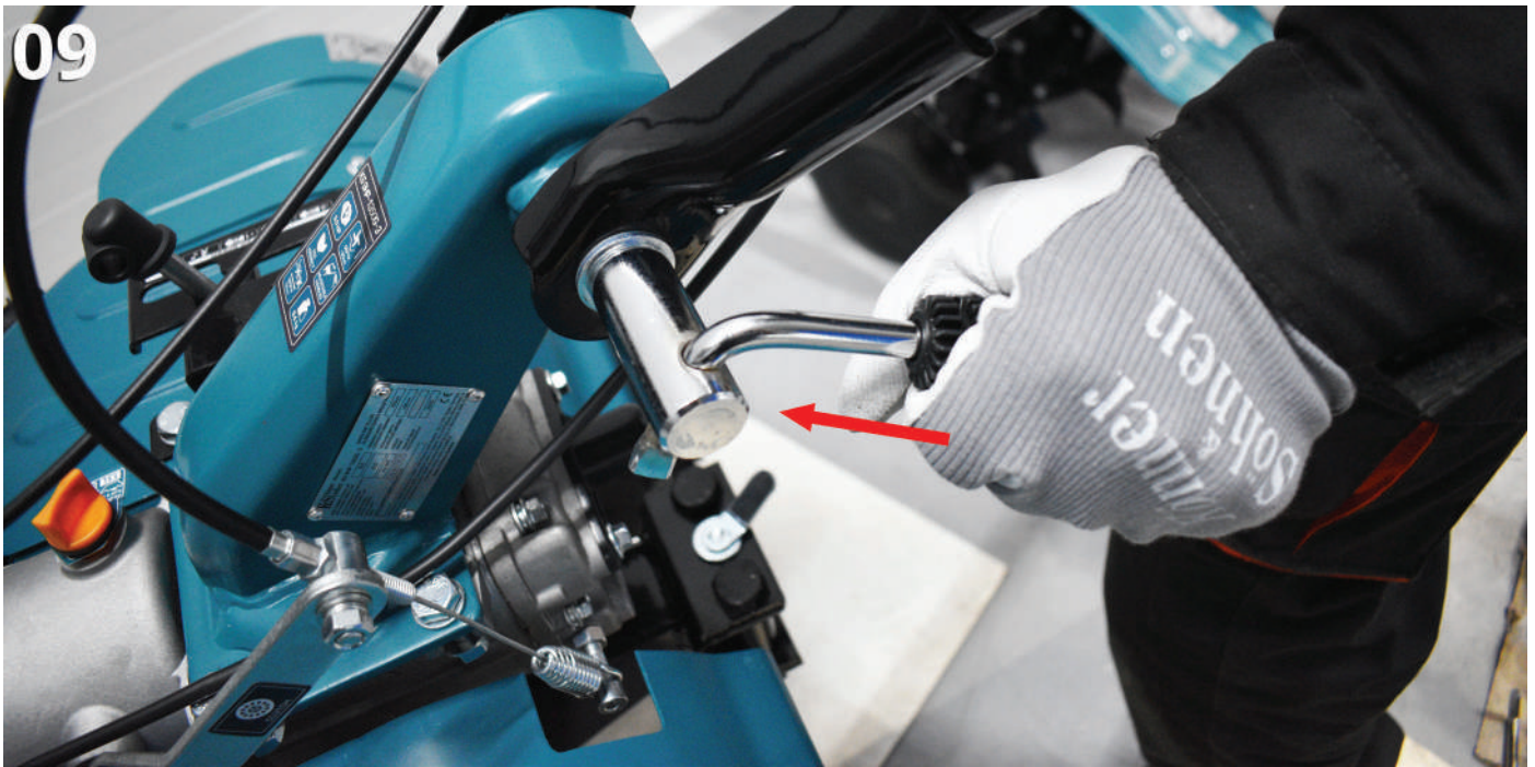
Fig. 10. Treceți șurubul prin ochiul arcului ambreiajului.
