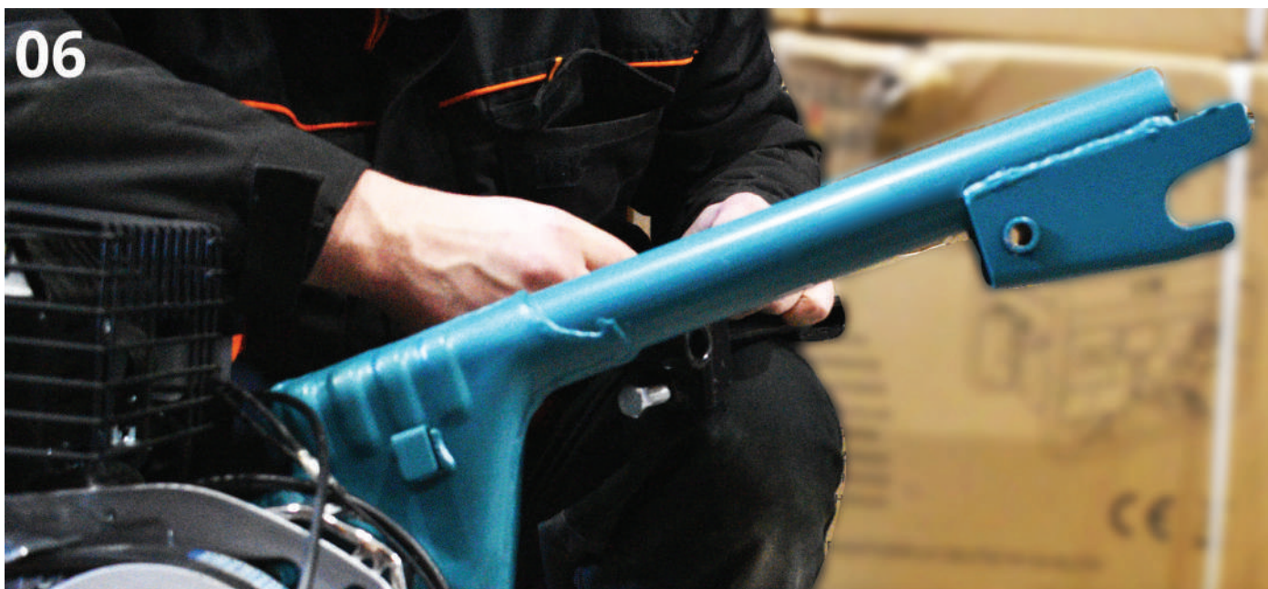
Мал.7. Фіксуємо положення ручки управління за допомогою зажимної ручки.
