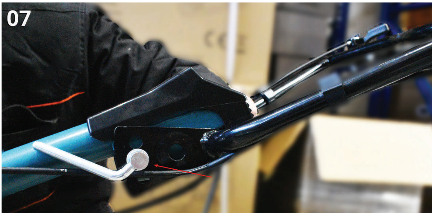
Мал.7. Фіксуємо положення ручки управління за допомогою зажимної ручки.
