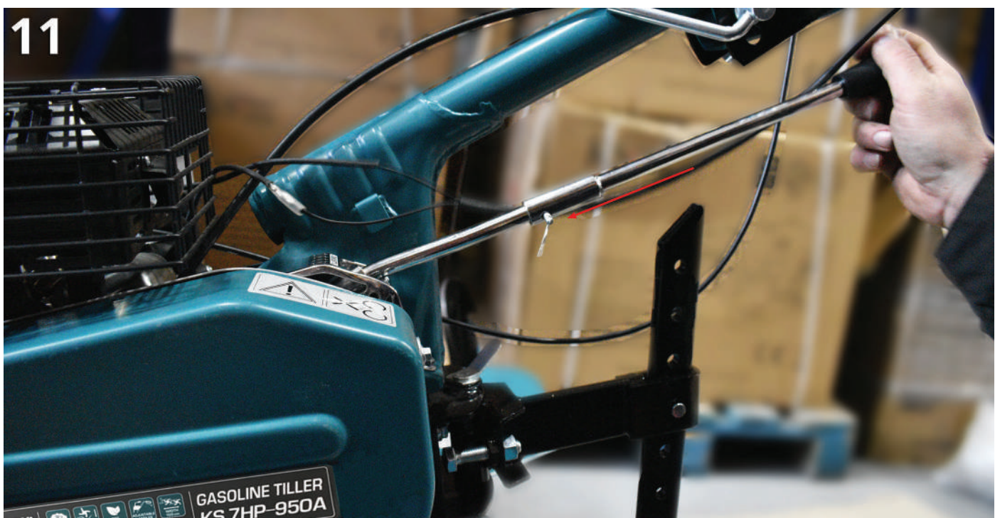
Rys.11. Przymocować przedłużenie dźwigni skrzyni biegów za pomocą sworznia blokującego, stabilizując go za pomocą zawlecзки.
