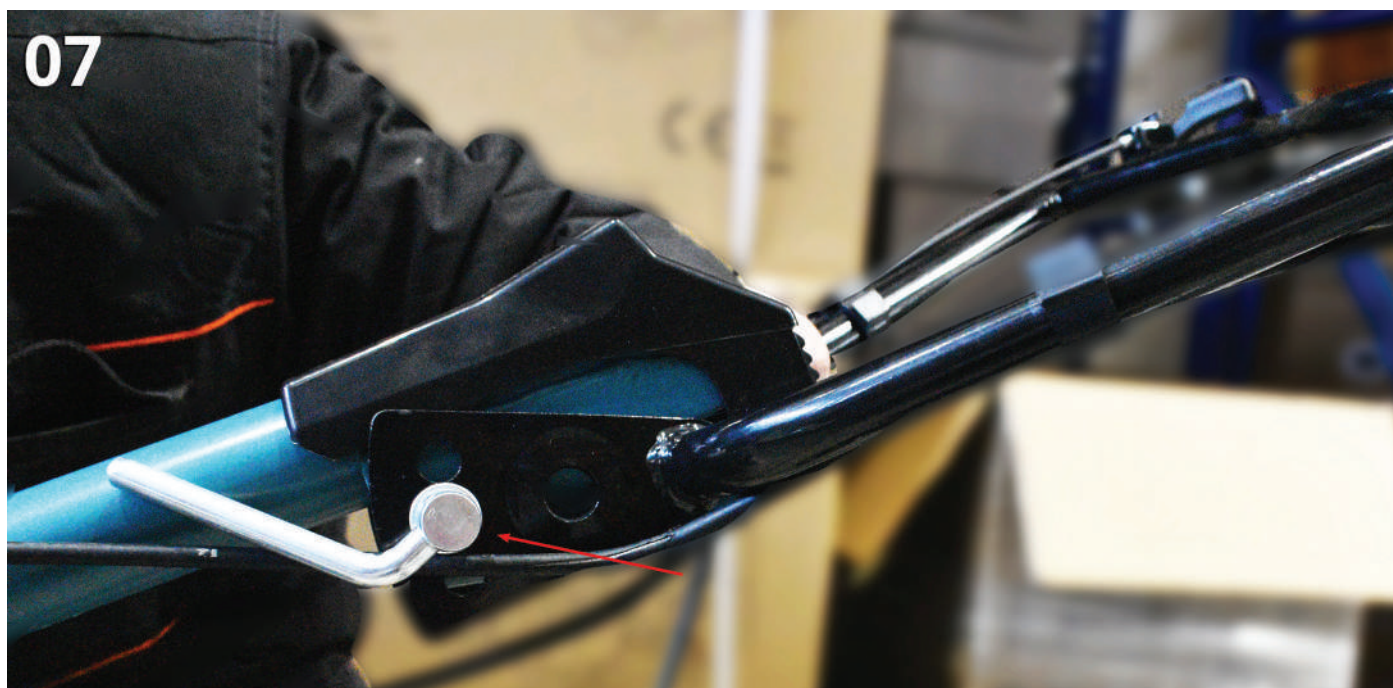
Rys.7. Ustabilizować pozycję uchwytu sterującego za pomocą zacisku uchwyty.
