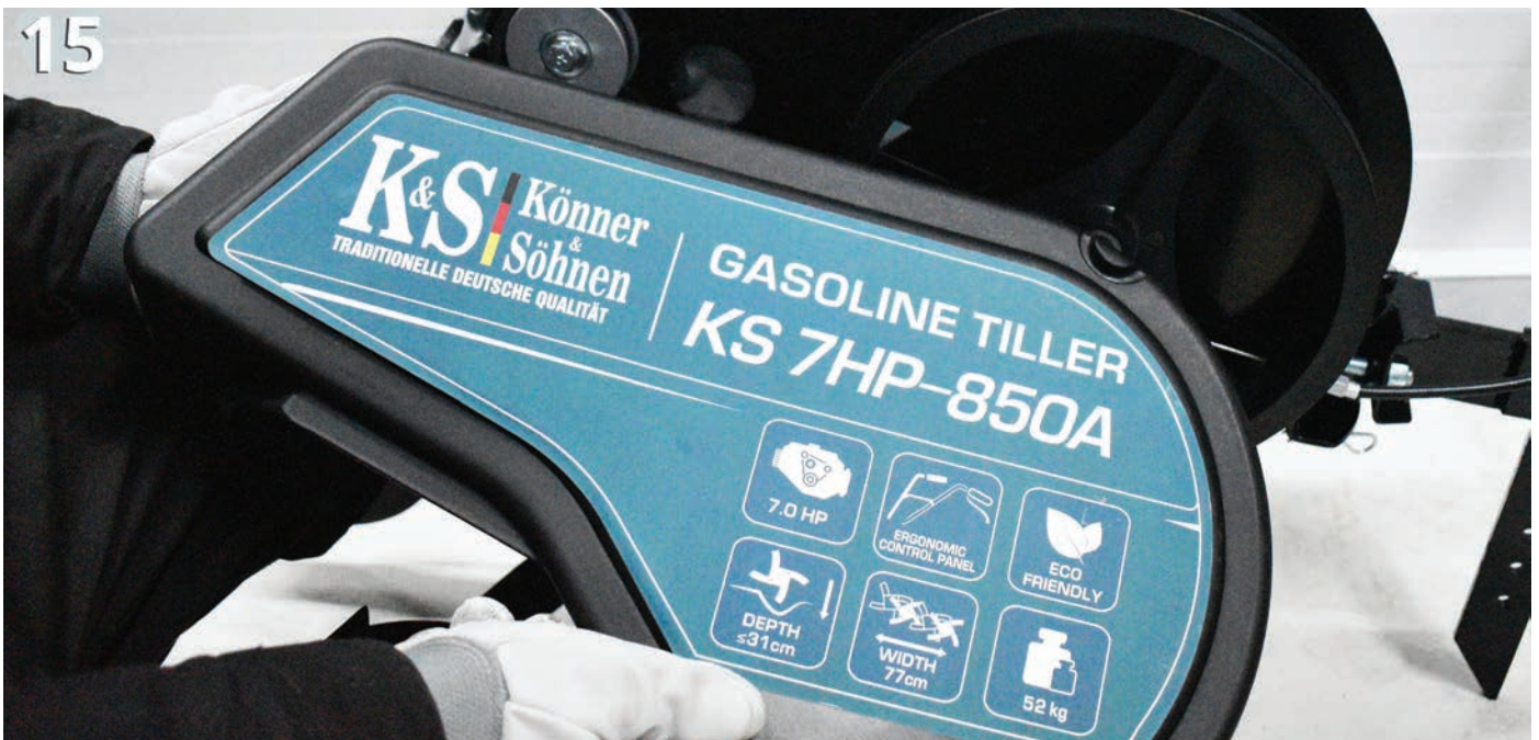
Fig. 15. Instalați capacul de protecție pe corpul cultivatorului.
