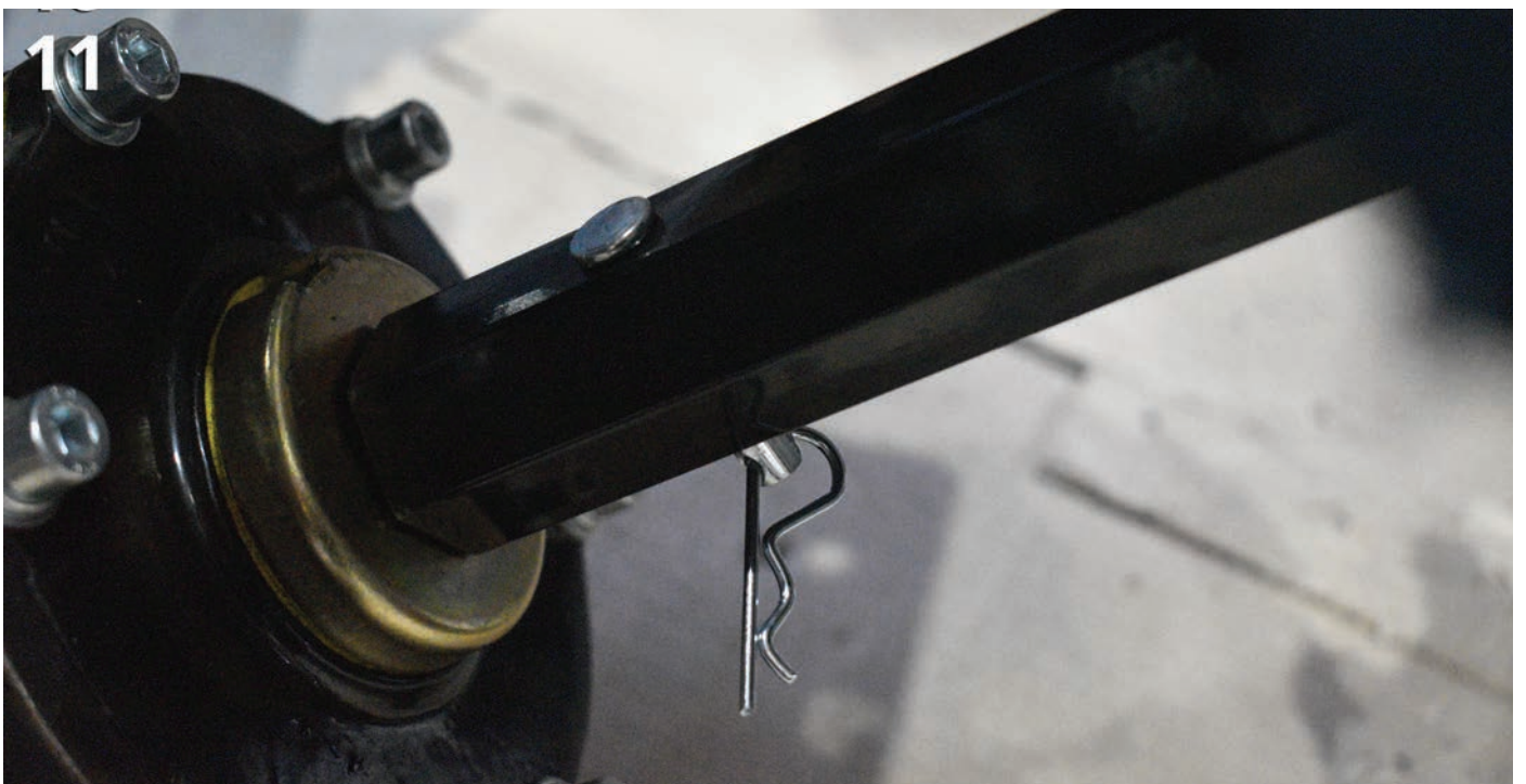
Fig. 11. Fixați semiaxul roții la arborele cutiei de viteze folosind un știft de blocare și un cui spintecat.
