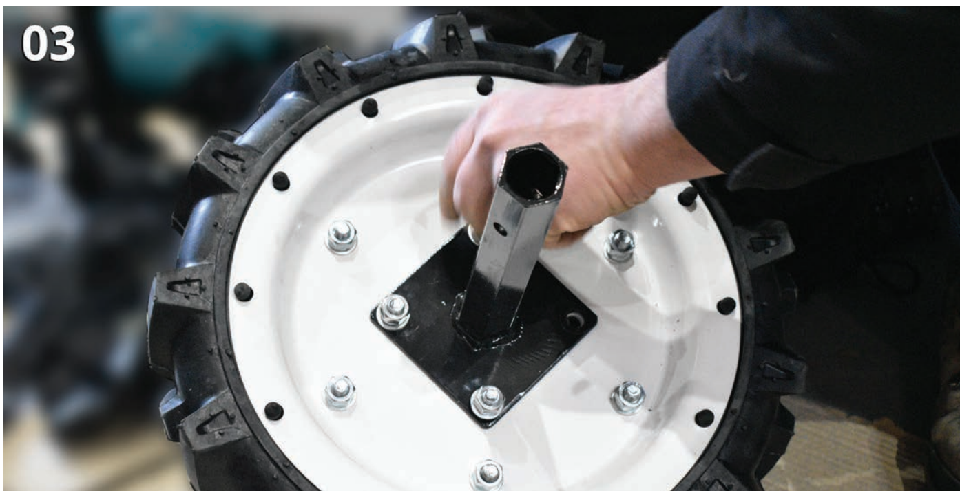
Fig. 3. Fixați roata de transport pe ax folosind șurub, piuliță și șaibă.
