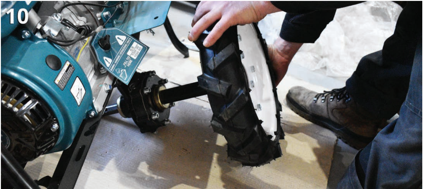
Fig. 11. Fixați semiaxul roții la arborele cutiei de viteze folosind un știft de blocare și un cui spintecat.
