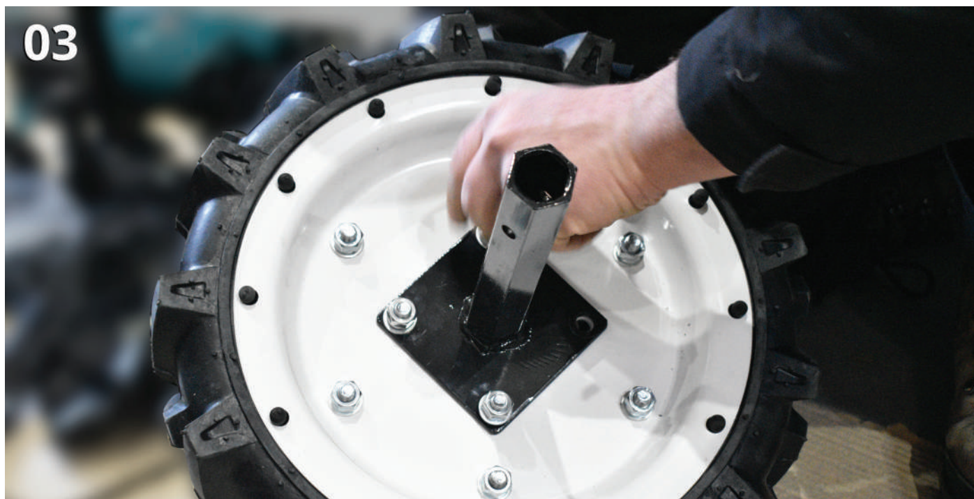
Rys.3. Mocowanie koła transportowego na osi za pomocą śrub, nakrętek i podkładki.
