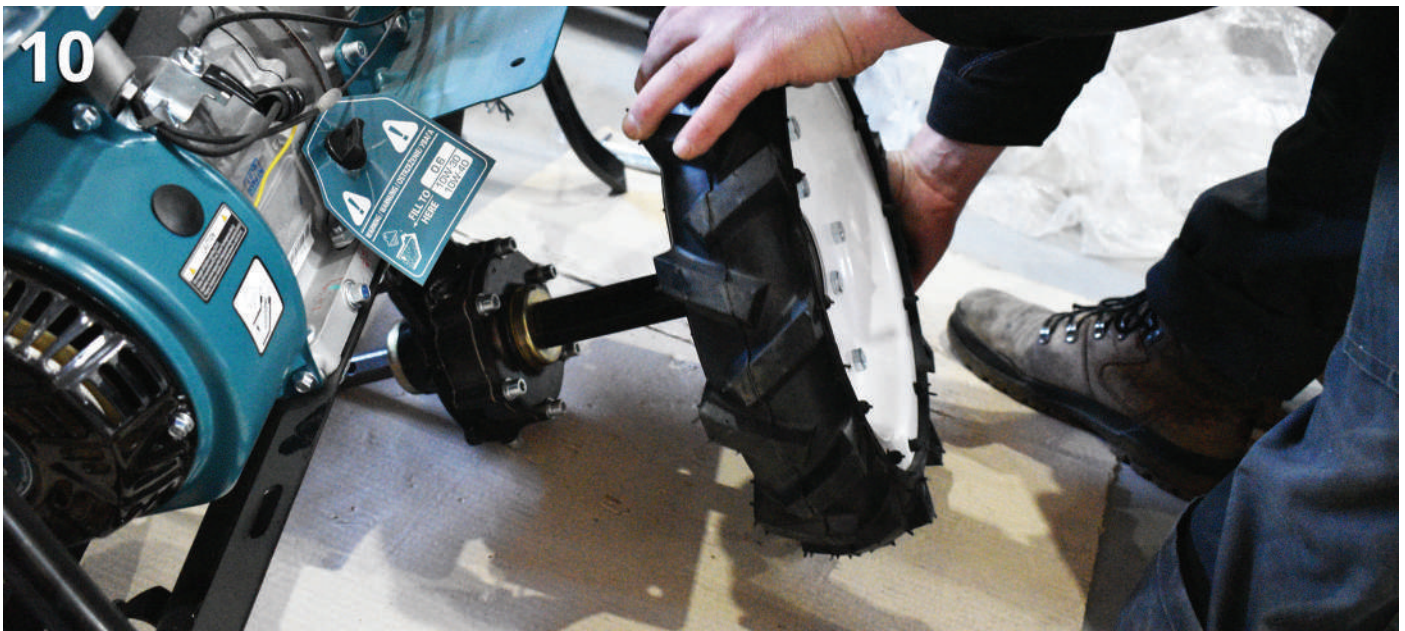
Rys.11. Przymocować półkoła do osi reduktora za pomocą sworznia blokującego i zawleczki.
