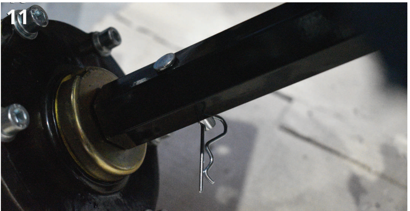
Rys.11. Przymocować półkoła do osi reduktora za pomocą sworznia blokującego i zawleczki.
