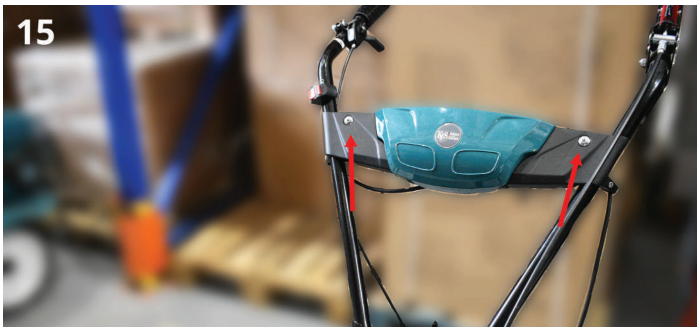
Rys.15. Przymocować skrzynkę do uchwyty sterującego za pomocą śrub i nakrętek.
