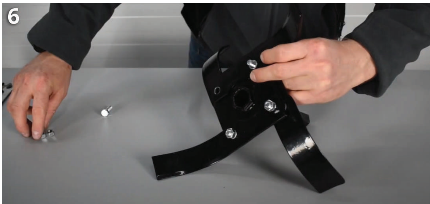
Rys.7. Sekcje noży łączymy między sobą za pomocą sworzni blokujących, które blokujemy zawleczkami.
