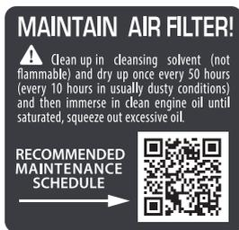
Der Luftfilter muss alle 50 Betriebsstunden gereinigt werden (bei erhöhter Verschmutzung alle 10 Stunden).
