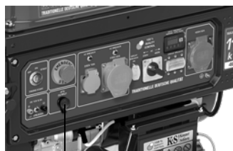
8-pinowe wyjście na generatorze do podłączenia ATS
